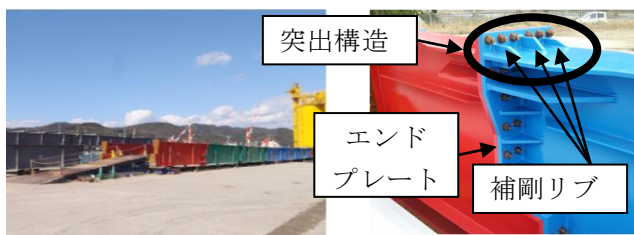
(a)緊急橋全景 (b)連結部の構造 図-1 国土交通省により開発された緊急橋
