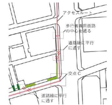
図 4 歩道なしの場合の距離の測定方法
