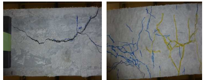
写真-1 L-300(左)と L-300-F(右) 供試体下面ひび割れ
