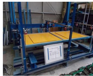
写真1 2スパンユニットの水平載荷試験供試体
