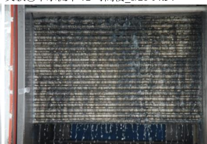
図 10 バイオフィルム付着状況 タイプ A 実験②下水流下 115 時間後_8/28 10:48
