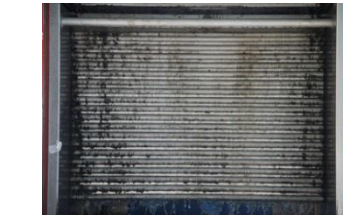
図25 タイプA 実験③ 下水で洗浄直後 熱通過率 1104W/m 2 K
