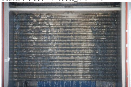
図 11 バイオフィルム付着状況 タイプ A 実験③下水流下 167 時間後_9/18 13:04
