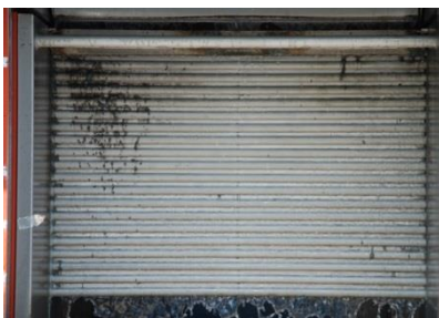
図 6 バイオフィルム付着状況 タイプ A 実験①下水流下 68 時間後_8/5 9:46
