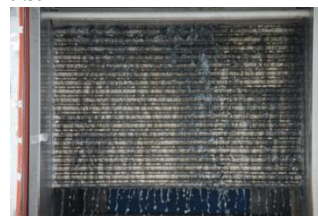
図22 タイプA 実験② 下水流下 115 時間後_8/28 10:48 熱通過率 751W/m 2 K
