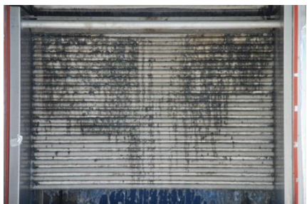
図 8 バイオフィルム付着状況 タイプ A 実験③下水流下 46 時間後_9/13 12:23
