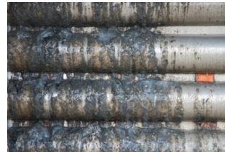
図18 下水流下 164 時間後 熱交換面左部分拡大図_12/6 9:39
