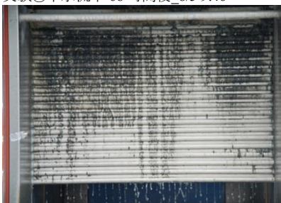
図 9 バイオフィルム付着状況 タイプ A 実験①下水流下 117 時間後_8/7 9:23
