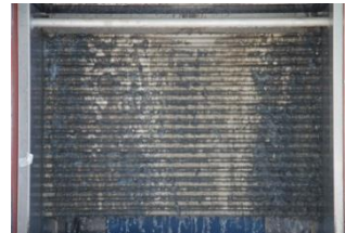
図24 タイプA 実験③ 下水流下 167 時間後_9/18 13:04 熱通過率 726W/m 2 K
