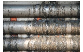
図19 下水流下 164 時間後 熱交換面右部分拡大図_12/6 9:40
