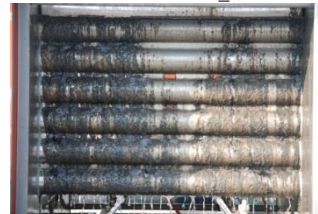
図20 ミスト洗浄実験前_12/6 9:39
