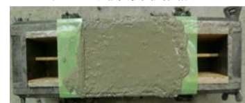
図-2.2 竹筋コンクリート埋め込み状況 図-6.2 打設後の写真
