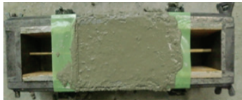
図-4.2 竹筋コンクリート埋め込み状況
