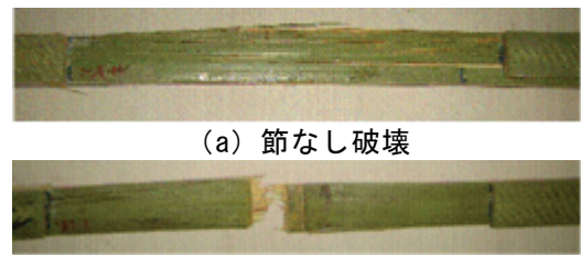
(a) 節なし破壊 (b) 節あり破壊 図-3.2 竹筋破壊状況
