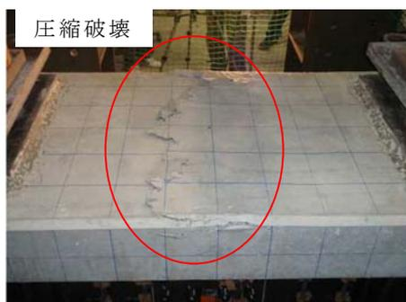
図-6 コンクリート床版上部圧壊 : Type-2
