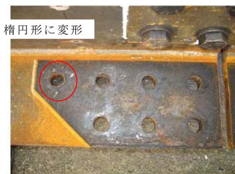
図-8 荷重後の下フランジ母板 : Type-2
